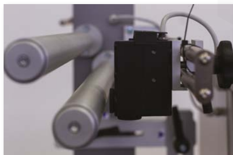
FOTOKOMÓRKA DO CENTROWANIA ZADRUKOWANEJ FOLII WZGLĘDEM PRODUKTU
