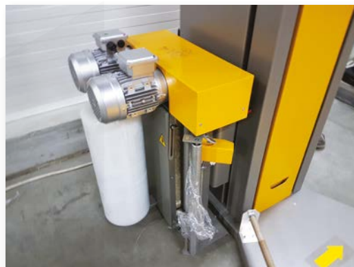
ZAAWANSOWANY DWUMOTOROWY ROZCIĄG FOLII
