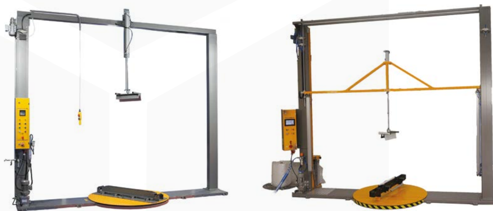
RAMOWE OWIJKI VR PRZEZNACZONE SĄ DO OWIJANIA DUŻYCH OKIEN.
