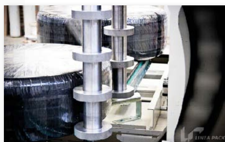
DOSTĘPNE W WERSJI DO OWIJANIA FOLIĄ PRODUKTÓW OKRĄGLYCH NP. OPON, WĘŻY, KABLI ITP.
