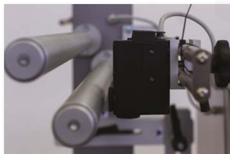
FOTOKOMÓRKA DO CENTROWANIA ZADRUKOWANEJ FOLII WZGLĘDEM PRODUKTU
