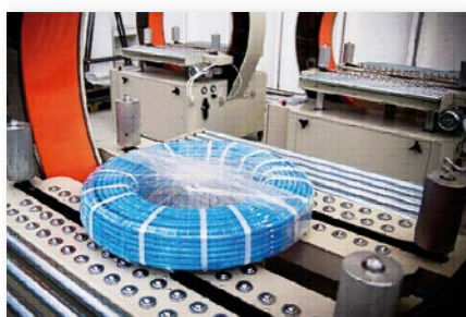
DOSTĘPNE W WERSJI DO OWIJANIA FOLIĄ PRODUKTÓW OKRĄGLYCH NP. OPON, WĘŻY, KABLI ITP.
