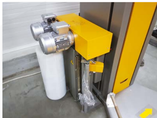
ZAAWANSOWANY DWUMOTOROWY ROZCIĄG FOLII
