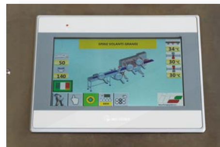
STEROWANIE ZA POMOCĄ KOLOROWEGO PANELU PLC, MOŻLIWOŚĆ PRZYPISANIA PROGRAMU DO PRODUKTU
