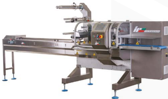
OBUDOWY MASZINY I ELEMENTY MAJĄCE KONTAKT Z PAKOWANYM PRODUKTEM WYKONANE ZE STALI NIERDZEWNEJ
